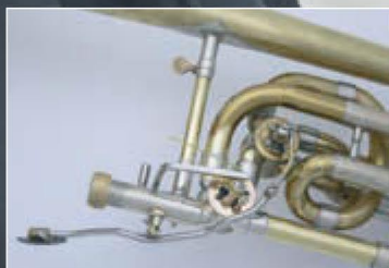
BLECHWERKSTATT REPARATUR EINES QUARTVENTILS
